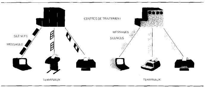
• Les terminaux se connectant peu souvent au centre de traitement utiliseront un réseau public à commutation de circuits afin de diminuer le coût de transmission, le circuit n'étant établi que durant les périodes de connexion (figure 2).
